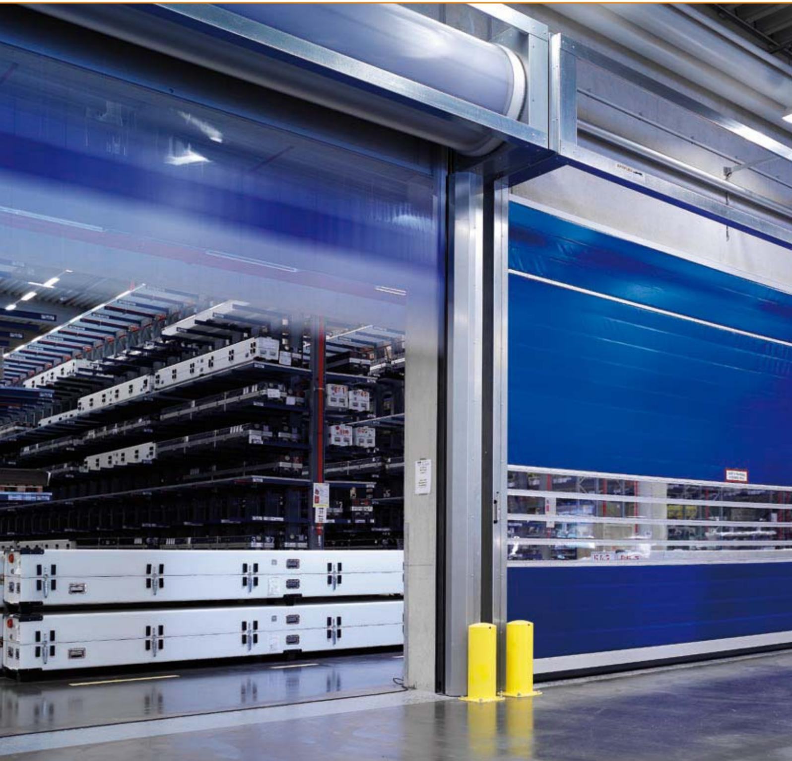
Für Sie haben wir das schnellste Tor der Welt gebaut. Durch die patentierte Spiraltechnik öffnet sich das EFA-STR® mit einer sagenhaften Geschwindigkeit von bis zu 4 m/s.
