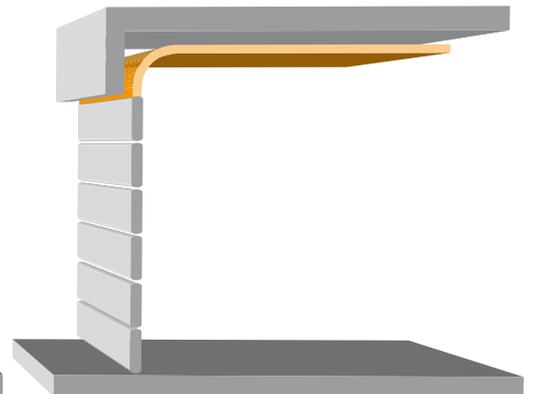
*Die Ausführung in Niedrigsturz gewährleistet höchste Sicherheit für Mensch und Fahrzeug, zum Beispiel in Tiefgaragen und Parkhäusern.*
