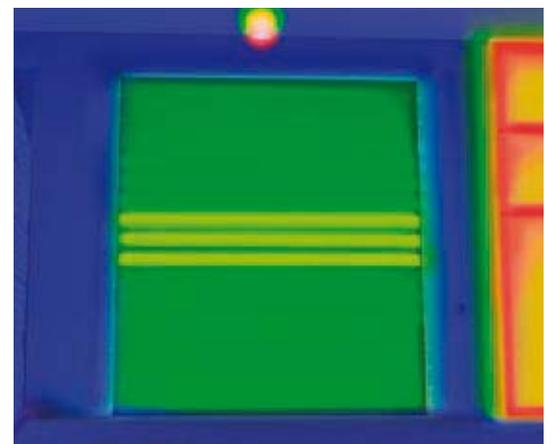
Als erster Hersteller von Schnellauftoren bieten wir Ihnen das EFA-SST® ab sofort serienmäßig mit thermisch getrennten EFA-THERM®-Lamellen. Diese verbessern die Wärmedämmung erheblich und senken somit Ihre Kosten für Energie.
