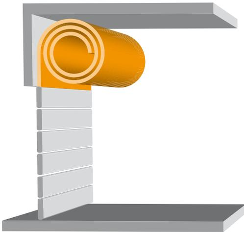
*Die runde Spirale ist Standard und die beste Lösung bei ausreichend Platz über dem Tor.*
